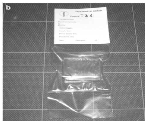
Fig. 2. Dispozitiv de măsurare pasivă a radonului: (a) diagrama și (b) poza (Bochicchio F. et al., 2009).
