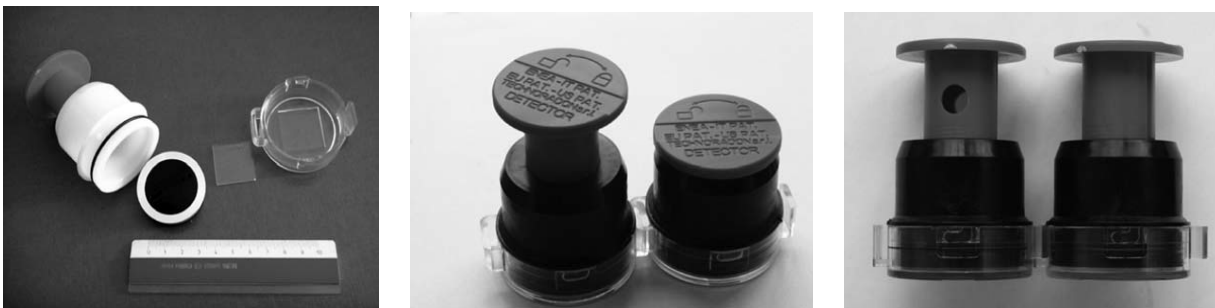
Fig. 4. Imagine a prototipului demontat (stânga): camera de difuzie, pistonul cu cadru de prindere din aluminiu, capacul transparent cu spațiu special pentru filmul de 10 mm 2 CR-39. Noul prototip A-PREM (centru) cu pistonul în poziția retrasă și poziția împinsă. Sistemul de măsurare discriminativ radon/toron (dreapta): de remarcat orificiul din piston a detectorului NTD-Rn/Tn (stânga) și detectorul standard NTD-Rn (dreapta).
